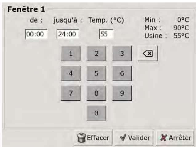
Fig. 9-8: Réglage des fenêtres horaires et de la température ECS
