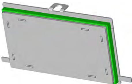
Repositionnez le couvercle intérieur et veillez à ce que celui-ci soit bien étanche. Fixez les attaches des paliers et fixez à nouveau le couvercle intérieur à l'aide du dispositif de verrouillage.
