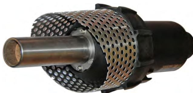
Démontez le tube d'allumage en desserrant les 4 vis et retirez la résistance d'allumage.
