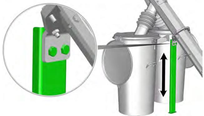
**Monter le passage pour la conduite de raccordement**
