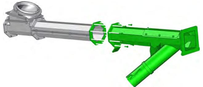
Fixez la béquille sur le canal d'évacuation à l'aide de 2 vis six pans M10 x 25.
