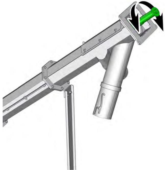
Collez un joint d'étanchéité sur la bride du canal d'évacuation.
