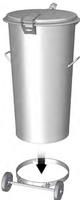
3. Serrez les 2 vis à six pans creux M10x50 sur le châssis du fût à cendres.
