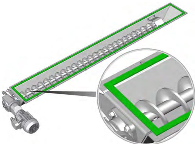
Fig. 10-9: Coller le joint d'étanchéité
