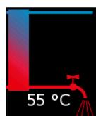
Le robinet d'eau situé à côté de l'échangeur de chaleur ne s'affiche que lorsque l'eau chaude sanitaire est délivrée dans le réseau par l'échangeur ECS. La température indiquée en regard correspond à la température ECS actuellement délivrée.
