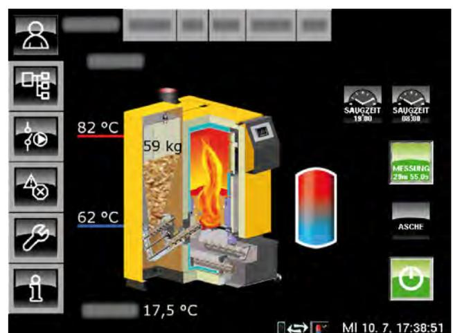
La chaudière fonctionnera désormais à puissance nominale pendant la durée réglée. La régulation garantit l'évacuation de chaleur requise dans les circuits de chauffage et le ballon ECS.
