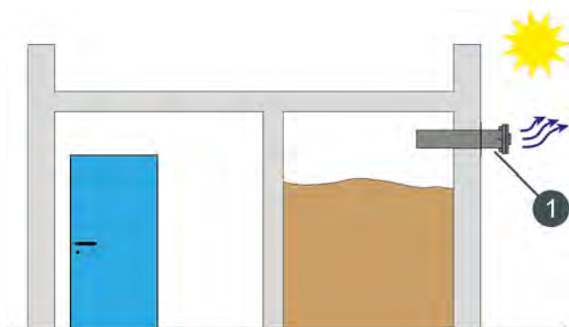
Fig. 13-10: Tubes de remplissage en plein air
