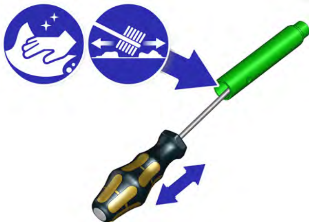
Fig. 2-49: Nettoyer le tube d'allumage
