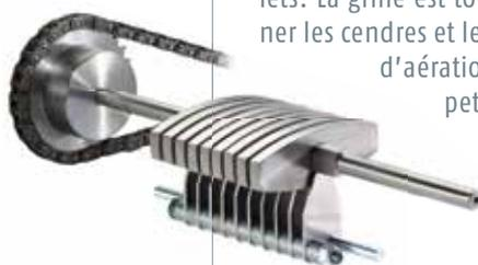
Un nettoyage est déclenché tous les 25 à 35 kg de pellets. La grille est tournée dans un peigne afin d'éliminer les cendres et les scories accumulées dans les fentes d'aération. Le lit de braises est attisé par de petits mouvements de la grille pour obtenir la meilleure fin de combustion possible avec une production de cendres minimale.
