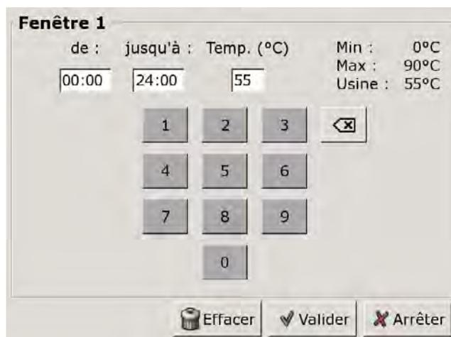
Fig. 8-15: Réglage des fenêtres horaires et de la température ECS
