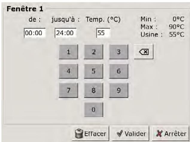
Fig. 8-33: Réglage des fenêtres horaires et de la température ECS
