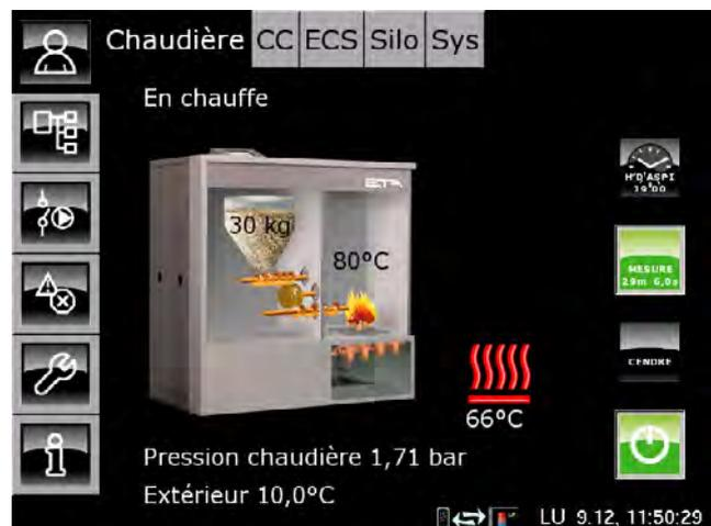
La chaudière fonctionne à puissance nominale pour la durée qui a été réglée. La régulation garantit l'évacuation de chaleur requise dans les circuits de chauffage et le ballon ECS.
