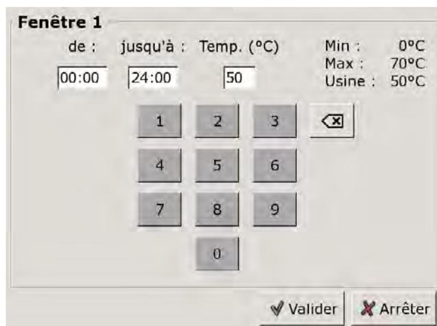
Fig. 8-21: Réglage des fenêtres horaires et de la température ECS
