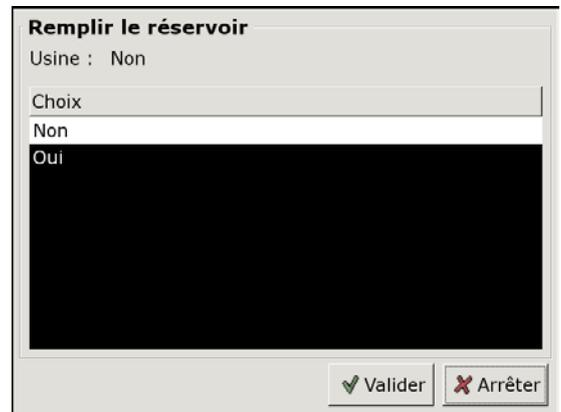
Dans la fenêtre de sélection, sélectionnez [Oui] et confirmez à l'aide de la touche [Valider]. L'aspiration démarre et le réservoir est rempli.
